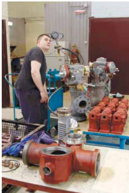
Сборка изделий на участке в арматурном комплексе
